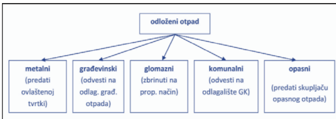
Slika 6: Tok otpada sa saniranog divljeg odlagališta
