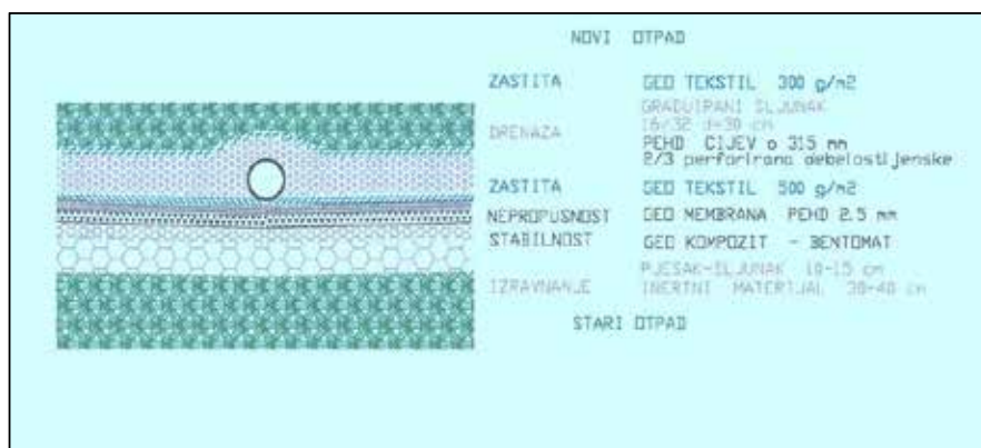
Slika 4: Presjek slojeva temeljnog brtvenog sustava
