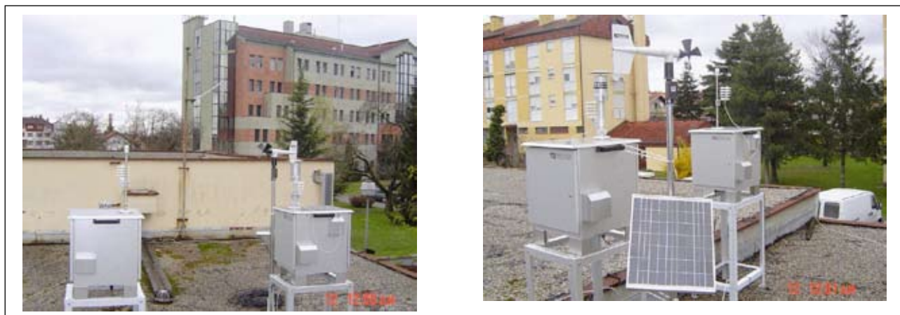
Slike 3 i 4: Postaja za automatsko uzorkovanje lebdećih čestica i plinova, lokacija Bolnica Varaždin
