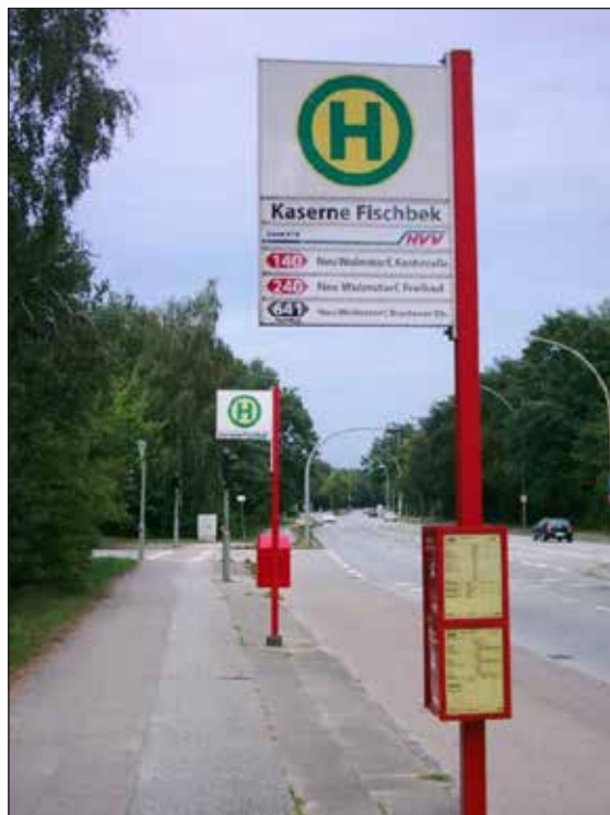
Slika 16.6. Stup, tabla i kvadar koji se koriste za označavanje autobusnih stajališta i informiranje korisnika na stajalištu autobusa Kaserne Fishbek u Hamburgu.
