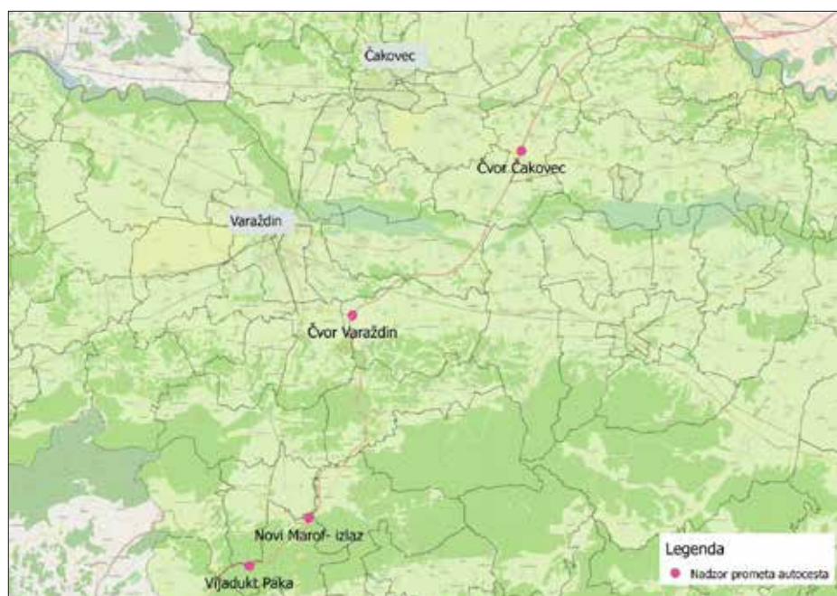
Slika 6.10. Pozicije kamera za praćenje prometa na autocesti A4 Izvor: Izradio autor temeljem GIS podloga i podataka dionika.
